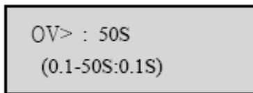
Fig 20) OVR > Tm(Time Multiply)設定目錄
