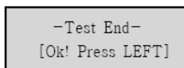
Fig 51) 跳脫測試結束顯示
