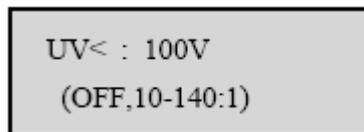
Fig 21) UVR < Pickup setup 目錄
